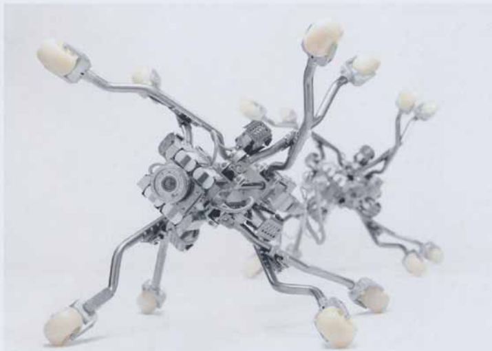
Bei der neuen Generation von UV-Lichtquellenkernen DN 500 - 1200 erfolgt die Nennweitenanpassung des Kerns mittels elektrischen Antriebs und kann über eine Kamera im Packer beobachtet werden. Mit einer Front- und einer Backkamera kann die Aushärtung visuell kontrolliert werden. | Foto: Prokasro Mechatronik GmbH
