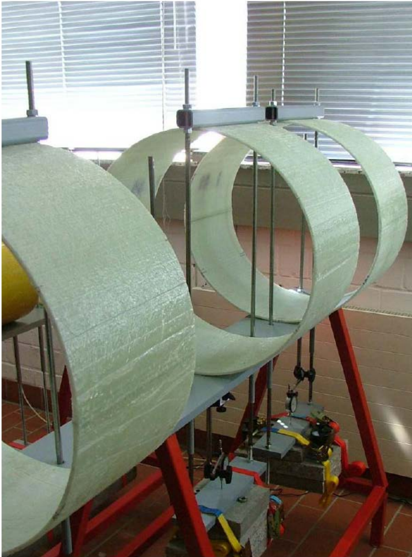
Bild 10 Langzeitscheiteldruckprüfung am Kreisring (Foto: IKT- Institut für Unterirdische Infrastruktur)
