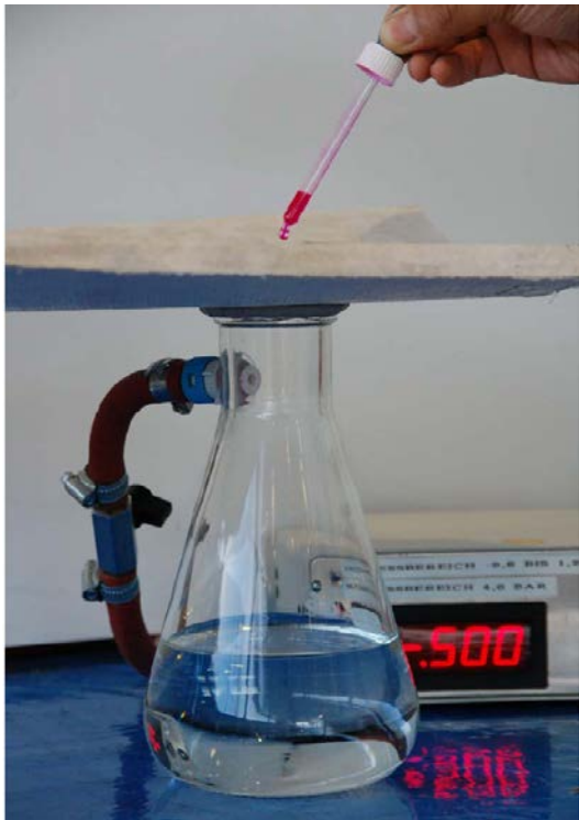
Bild 3 Prüfung der Wasserdichtheit mittels Unterdruck (Foto: IKT- Institut für Unterirdische Infrastruktur)
