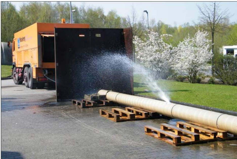
Bild 8 Praxisprüfung nach DIN 19523 (Foto: IKT- Institut für Unterirdische Infrastruktur)
