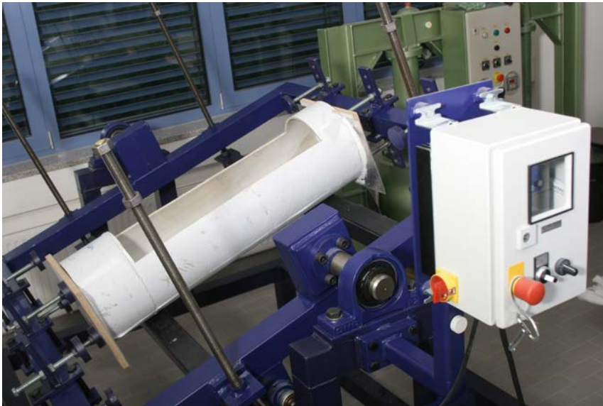
Bild 5 Abriebprüfung mittels "Darmstädter Kipprinne" (Foto: siebert + knipschild GmbH, Ingenieurbüro für Kunststofftechnik)
